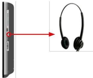
Der Kopfhörer wird an der rechten Seite des Cockpits angesteckt.
